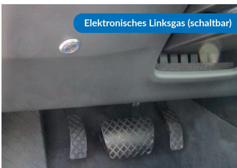
Elektronisches Linksgas (schaltbar)
