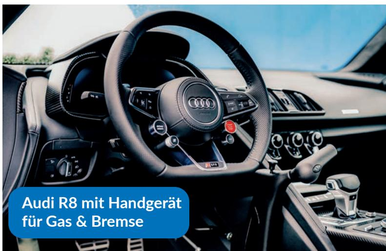
Audi R8 mit Handgerät für Gas & Bremse
