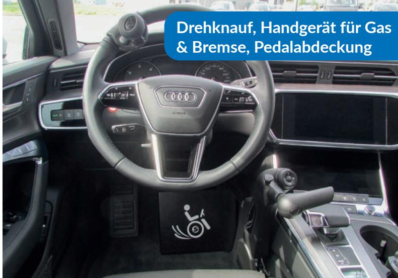
Drehknopf, Handgerät für Gas & Bremse, Pedalabdeckung
