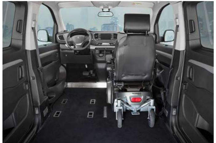
Tiefgelegter **barrierefreier Fahrzeugboden** von der A-Säule bis zur C-Säule für mehr Kopffreiheit.
