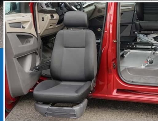
Den Volkswagen T7 Multivan haben wir mit verschiedensten Umbaumöglichkeiten für Selbstfahrer und Beifahrer getestet. Beispielsweise haben wir unterschiedliche Hecklifte ausprobiert, darunter den bewährten Panoramalift mit einer maximalen Traglast von bis zu 400 kg. Alternativ ist auch ein seitlicher Kassettenlift möglich. Im Inneren des Multivans haben wir durch die Bodenabflachung deutlich mehr Kopffreiheit geschaffen.
