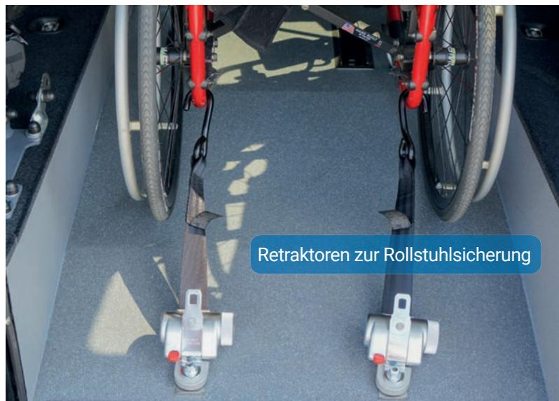
Retraktoren zur Rollstuhlsicherung
