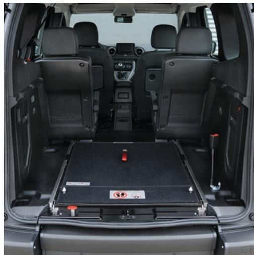
Die eingeklappte EasyFlex Rampe ermöglicht die volle Nutzung des Kofferraums.
